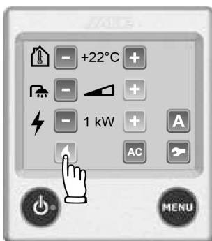
Bild 149: Värma upp med gasol
