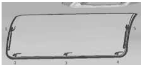
Bild 31: Vy invändigt av välvt utåt öppningsbart fönster med fem låsved
