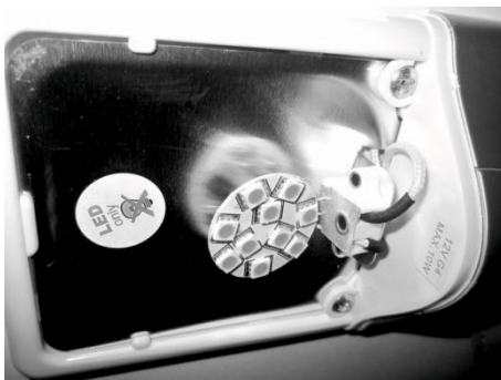
Fig. 173: Remplacement de l'ampoule LED
