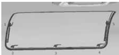
Fig. 37: Vue intérieure de la baie ouvrante galbée à cinq poignées de verrouillage
