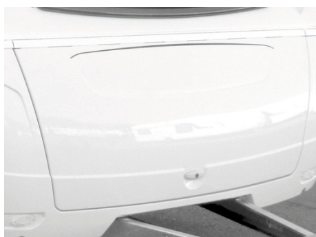
Fig. 108 : Caisson pour les bouteilles de gaz
