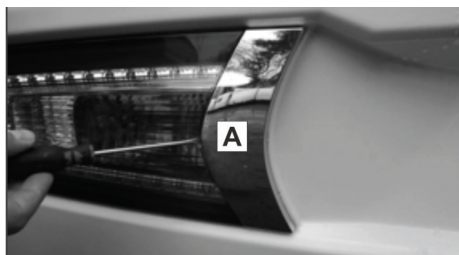
Fig. 174 : Support de l'éclairage arrière
