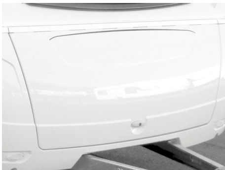
Fig. 106 : Caisson pour les bouteilles de gaz
