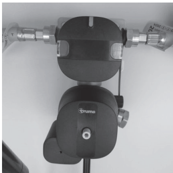
Bild 78: Gasolsystem (med Eis-Ex och fjärrindikator)
