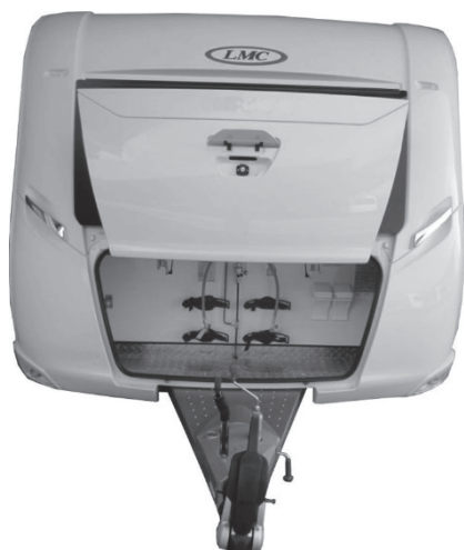
Bild 76: Gasollådans lucka, öppen
