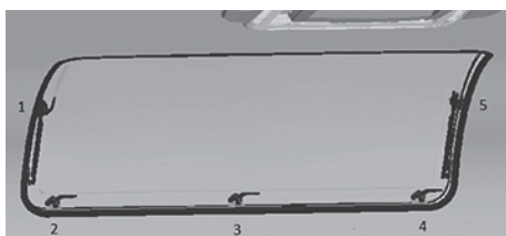
Bild 28: Vy invändigt av välvt utåt öppningsbart fönster med fem låsvred
