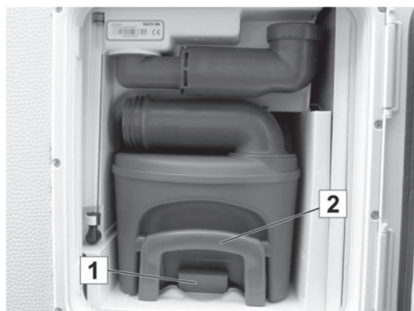
Bild 199: Fekalietank i avfallsschaktet
