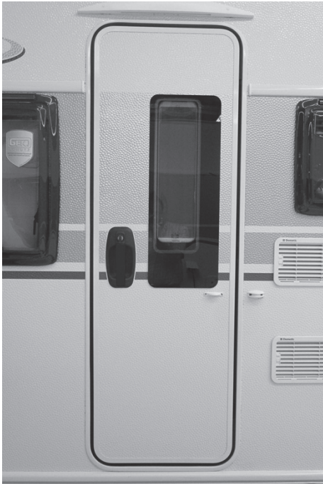
Bild 12: Ingångsdörr med fönster (exempel)
